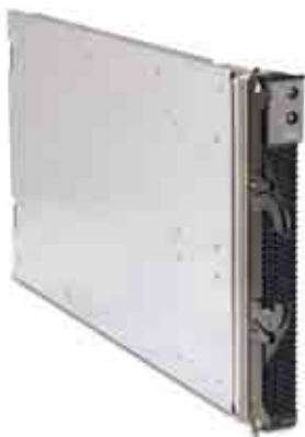
Sie können bis zu 14 2-Wege-Blades vom Typ HS20 in ein einzelnes BladeCenter Chassis einbauen
